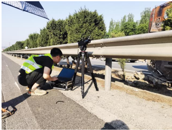
图 3 挠度测试仪器安装与调试
