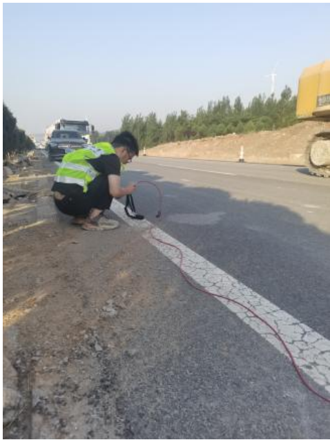
图 7 应变测点安装
