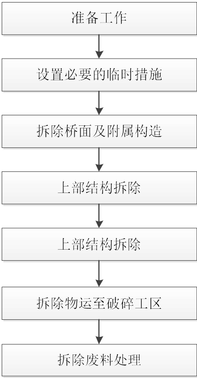
图2 跨线桥梁拆除顺序图
