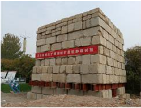
图 1 SZ-4 静荷载试验现场图片 (2022. 10. 30~11. 1)
