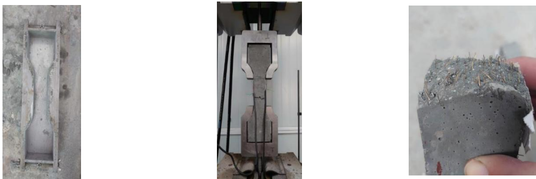
图 2 直拉试验模具及试件破坏情况
