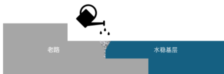
图2 接缝处浇灌水泥浆示意图
