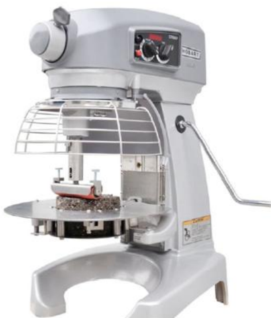
图 A.1 扫刷试验仪
